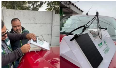
Trampas con IA para el monitoreo de C. capitata . Fuente: Reporte Agrícola, 2026.
